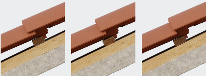
FLEXIBILIDADE DE RIPADO | GAUGE FLEXIBILITY FLEXIBILITÉ DU POREAU | FLEXIBILIDAD DE RASTRELADO Máx. | Max. 39 cm Mín. | Min. 37 cm
