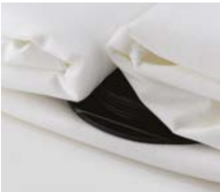
ADAPTADOR DE MEMBRANA TERMOSELLADA La membrana geotextil, con 4 capas en su composición, dos interiores de EVA y dos exteriores de tela no tejida, permite una mayor impermeabilización y canalización del agua a través del sifón.
