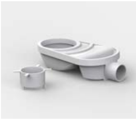
SIFÓN Sifón con altura de 58mm, diseñado para un drenaje eficiente (28 l/min), fácil limpieza y mantenimiento. Este Sifón incluye un adaptador con membrana sellada de fábrica y requiere una altura total de instalación de 70mm.
