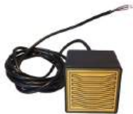
SENSOR DE CHUVA: J-G4G O sensor da chuva deve ser colocado no exterior, a céu aberto onde possa ser atingido pela precipitação. Pode ser adicionado a uma janela eléctrica. Este produto fecha automaticamente a janela quando o sensor é molhado por pingos de água (Insensível ao nevoeiro, gelo, orvalho e humidade).
