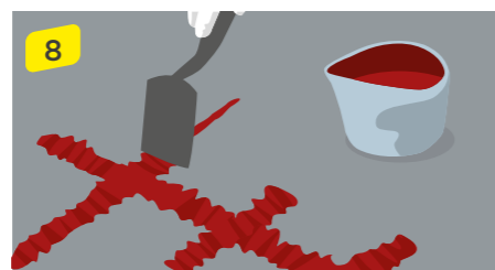
8 Preenchimento total da fissura e remoção de material excedente.
