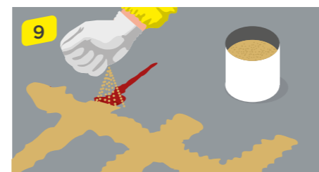
9 Saturação da fissura tratada com sílica sobre resina ainda em fresco para criação de ponte de aderência.
