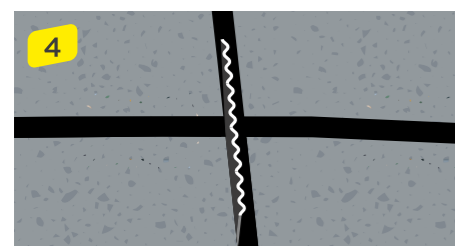
4 Colocação de barra metálica de reforço nos cortes perpendiculares à fissura.
