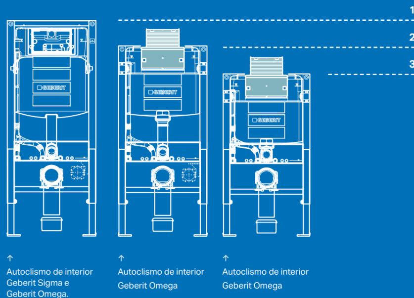
1 Altura de instalação 112 cm. 2 Altura de instalação 98 cm. 3 Altura de instalação 82 cm.
