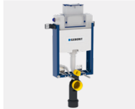
↑ Estrutura Geberit Kombifix para sanitas suspensas, de 98 cm, com autoclismo de interior Omega de 12 cm. 110.011.00.1
