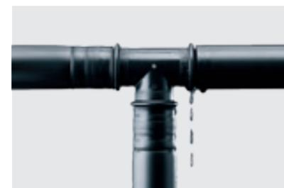
As fugas de água definidas tornam os acessórios não comprimidos imediatamente visíveis no teste de pressão.
