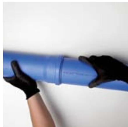
Um sistema adaptado às variações de temperatura: **a dilatação térmica do Triplus® é extremamente baixa em comparação com os mais comuns materiais plásticos**: um tubo de 3 m alonga-se apenas 9 mm quando o caudal de drenagem é a uma temperatura contínua de 60°C.
